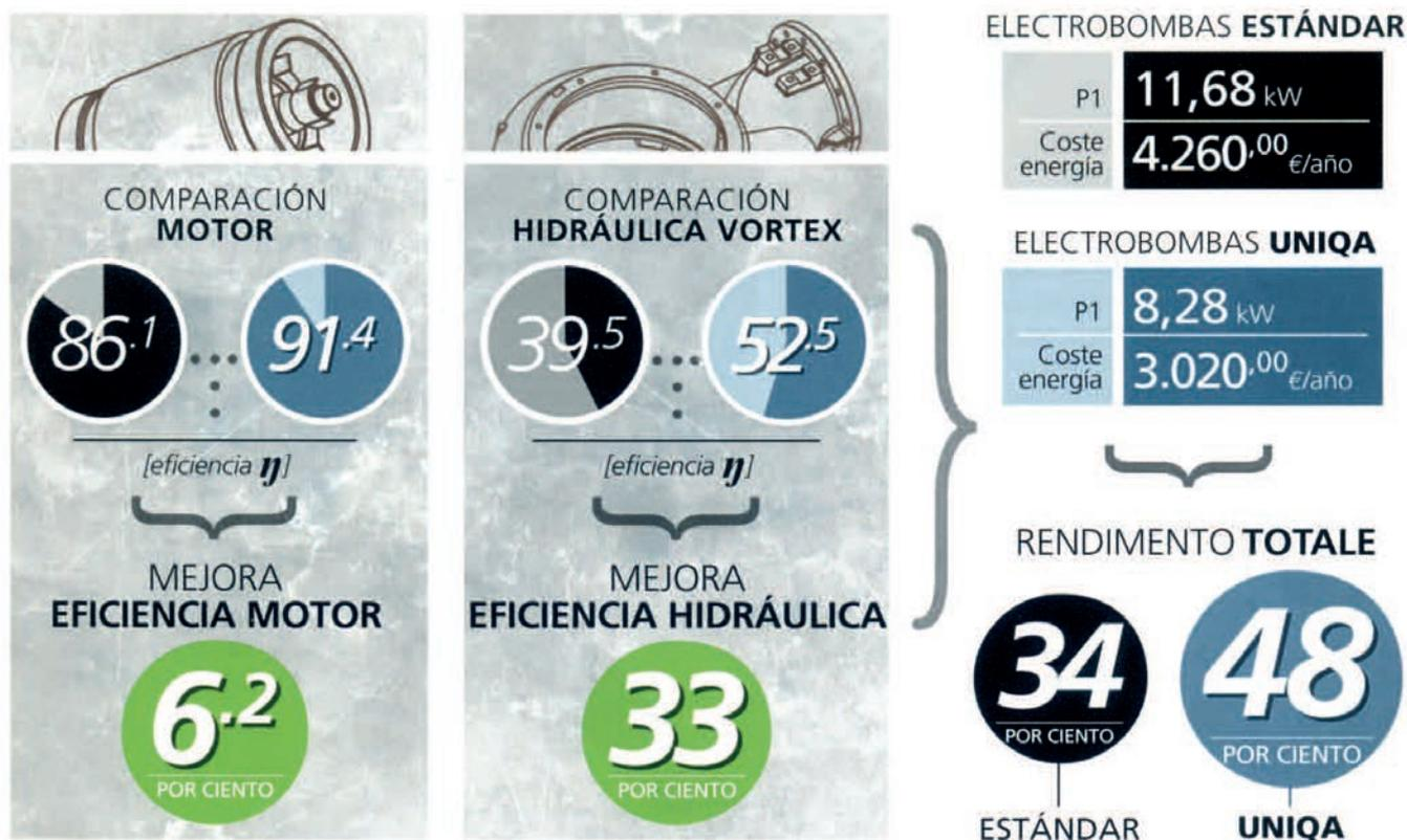
En el ejemplo es evidente que, gracias al uso de una electrobomba UNIQA provista de motor con eficiencia PREMIUM IE3 (+6,2%) y de hidráulica de alto rendimiento (+33%), respecto de una electrobomba STANDARD se obtiene un aumento del 6 por ciento del rendimiento total del sistema en el punto de trabajo requerido, obteniéndose así un notable ahorro económico.
