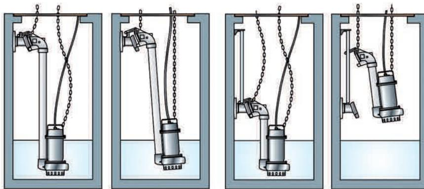
En las instalaciones en que se requiera fijar el DAC-E lejos de la tapa del sumidero, se podrá recurrir al uso de dos tubos guía (de 3/4"), útiles para acompañar la electrobomba hasta obtener su correcto acoplamiento.
