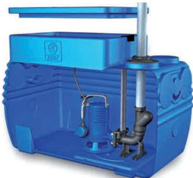
Las **estaciones de elevación** prefabricadas constituyen una solución eficaz y económica para recoger y reenviar aguas residuales domésticas a la red de alcantarillado cuando ésta se encuentra a un nivel superior, por lo tanto inalcanzable por gravedad, o bien en caso de tener que efectuar trituración de residuos.
