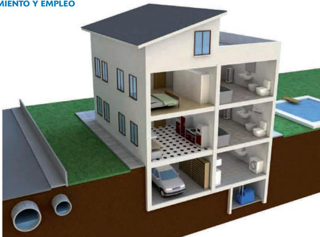
El depósito de recogida recibe las aguas residuales domésticas provenientes de desagües de cualquier naturaleza y de eventuales trampas receptoras de aguas pluviales o de infiltración.
