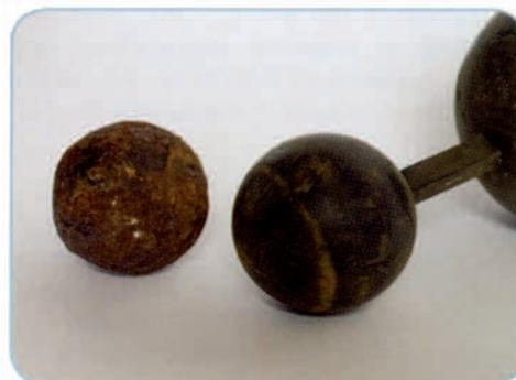
He aquí como se presenta, un año después de la instalación, una bola metálica normalmente utilizada en las válvulas de fluidificación de la competencia (a la izquierda) y la bola de goma empleada en la FLX Zenit
